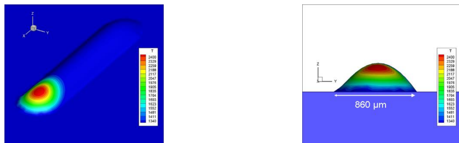
Bild 5: Berechnete Temperaturfelder in der Aufsicht und im Querschliff. Lokale Erstarrungsbedingungen wie Temperaturgradienten und Spurgeometrie sind Teil der Lösung
