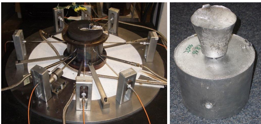
Abb. 1: Versuchsaufbau (l.) und rotationssymmetrischer Napf (r.)
