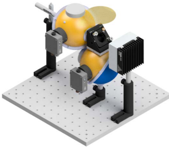
Bild 1: Messaufbau mit Ulbricht-Kugel zur Analyse des Einkoppelgrades
