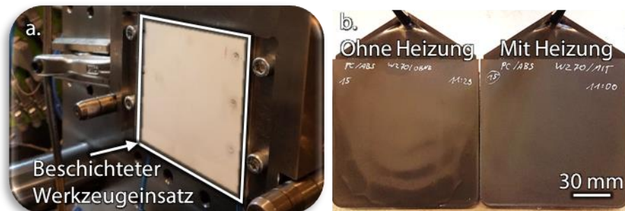
Abbildung 3: a. Beschichteter Werkzeugeinsatz in Spritzgießanlage; b. Ohne und mit Heizung des Werkzeugeinsatzes hergestellte Formteile
