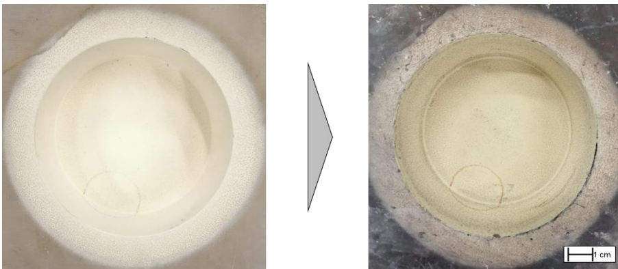
Abb. 2. Zu sehen ist die Kavität der Qualifizierungsversuche der YSZ-Beschichtung vor (links) und nach (rechts) von 450 Gießzyklen.
